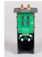
Pour une entrée MC, l'impédance et la capacité de l'entrée peuvent être réglées via les interrupteurs situés sous le tiroir. Deux blocs d'interrupteur pour la voie droite, deux pour la gauche. Côté avec les numéros, l'interrupteur est ouvert. Côté « ON », il est fermé. Chaque interrupteur fermé viendra ajouter la valeur écrite sur la droite aux autres interrupteurs du bloc.
