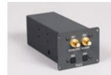
**DAC:** Cette extension DAC comporte deux entrées RCA et deux entrées optiques. Cette conversion est en 32 bits - 768 kHz.
